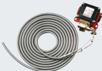
Trekschakelaar met kunststof trekkoord Montage horizontaal of verticaal mogelijk, behuizing van gegoten aluminium IP 65, lengte trekkoord 4 m
