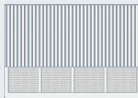
Motief 414 Geprofileerde staalplaat met geperforeerde plaatvulling
