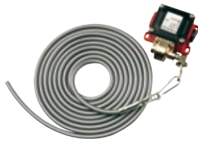
Trekschakelaar met kunststof trekkoord Montage horizontaal of verticaal mogelijk, behuizing van aluminium spuitgietzink, IP65, kabellengte 4 m
