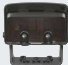
Radarbewegingsmelder MWD snelle en gerichte automatische deuropening, richtingsherkendend, max. montagehoogte 7 m, montage in diepvrieszone mogelijk tot maximaal -22 °C, IP 65
