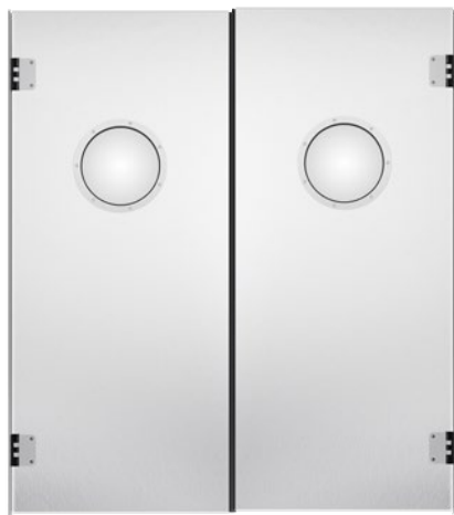
2-vleugelige uitvoering Openingshoek 2 × 90° Breedte in mm: 1100 – 2900 Hoogte in mm: 1800 – 2800
