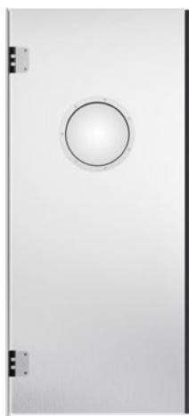
1-vleugelige uitvoering Openingshoek 2 × 90° Breedte in mm: 550 – 1450 Hoogte in mm: 1800 – 2800
